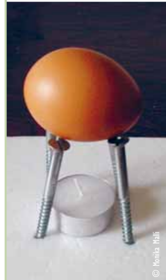
Versuch I: Der entweichende Wasserdampf ist der „Motor“ für das Ei-Dampfschiff.
